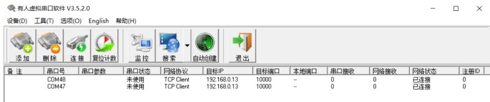
此时打开串口助手工具，即可看到刚才创建的 COM47、COM48 了，此时就可以通过虚拟串口与以太网协议转换器通信了。
