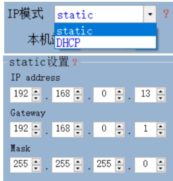
设备支持 static 静态 IP 模式，和 DHCP 自动获取模式，当使用“DHCP”时，“static 设置”的内容用户可忽略，设备将自动获取相关信息。
