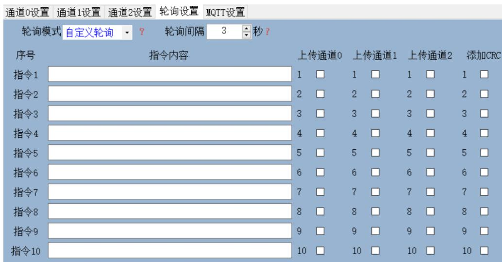
在 TCP client、TCP server、UDP client、UDP server、双服务器、三服务器、MQTT 模式下，设备支持主动下行轮询数据，并将接收到的数据立刻返回到指定通道。
