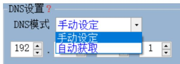
在 DHCP 模式下，DNS 可选择“自动获取”或“手动设定”；在 static 模式下，DNS 只可配置成“手动设定”。
