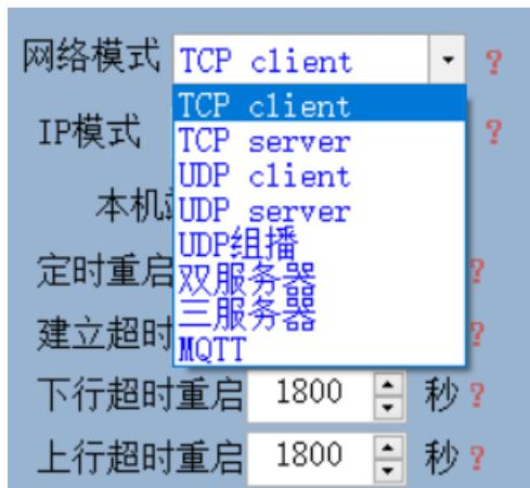
**TCP client:** 设备作为客户端，上电将主动连接远程服务器。该模式下只支持 1 个 socket 链接。
