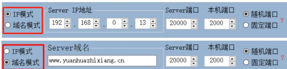
设备支持使用 IP 方式，或者域名方式连接服务器，自带 DNS 域名解析功能。
