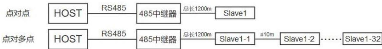
(2) 级联 (树形连接); 接 N 个 485 中继器, 无限延长 RS485 通信距离, 拓展更多 485 设备, 最大支持连接 32 设备。
