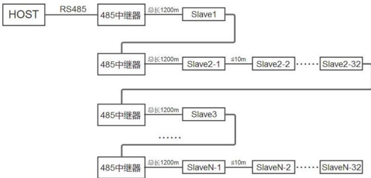
(3) 并联最大支持 32 个 485 中继器并联在同一个 485 设备上，同时最大支持连接 32 个设备。
